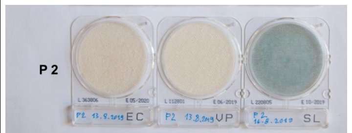
Les analyses bactériologiques n'ont révélé aucune trace d'Escherichia Coli, de vibron du choléra ou de salmonelles (de gauche à droite). Les résultats sont identiques dans le puits P1.
